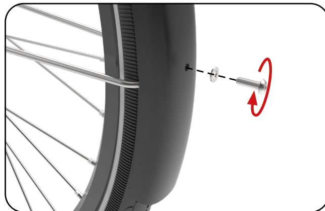
3 - Montage van spatbordstang aan voorvork
