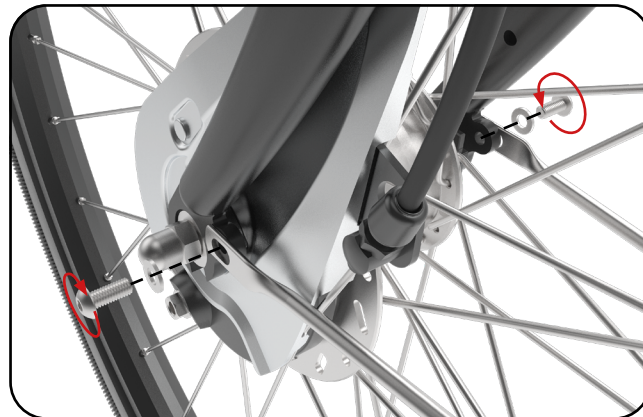
3 - Montage van spatbordstang aan voorvork
