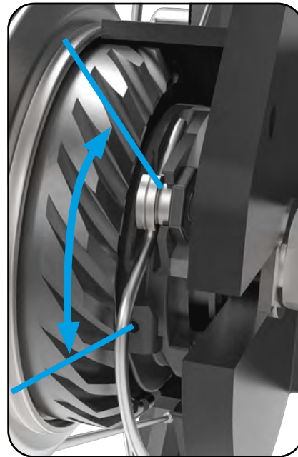
15 - Plaatsen van de versnellingskabel
