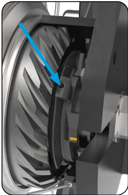
14 - Voorbereiden van de cassette joint
